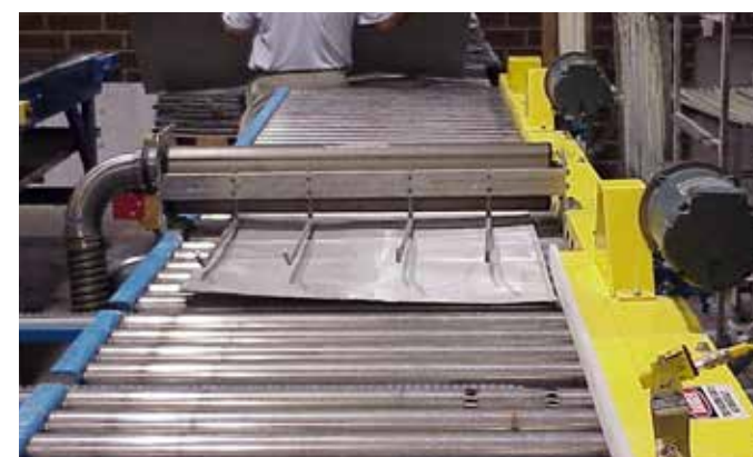
Blech-Stanze V= 30 m/min.
