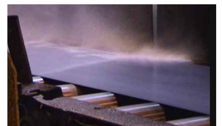
Seitliche Abblasung V= 550 m/min.
