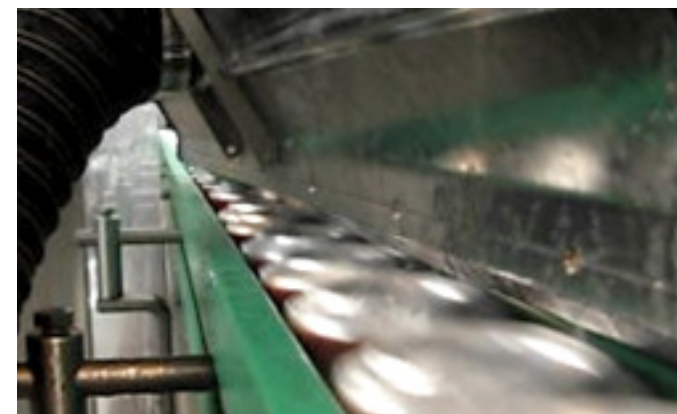
Dosenbodenabbläsung 120.000 Dosen / Stunde
