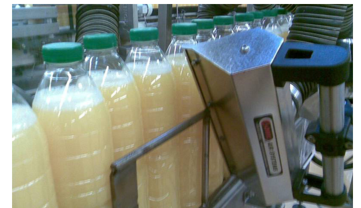
Flaschenabbläsung Bis 60.000 Flaschen / Stunde
