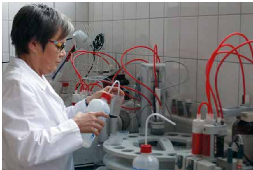
Durchführung einer chemischen Analyse mittels vollautomatischer Titrierstation
