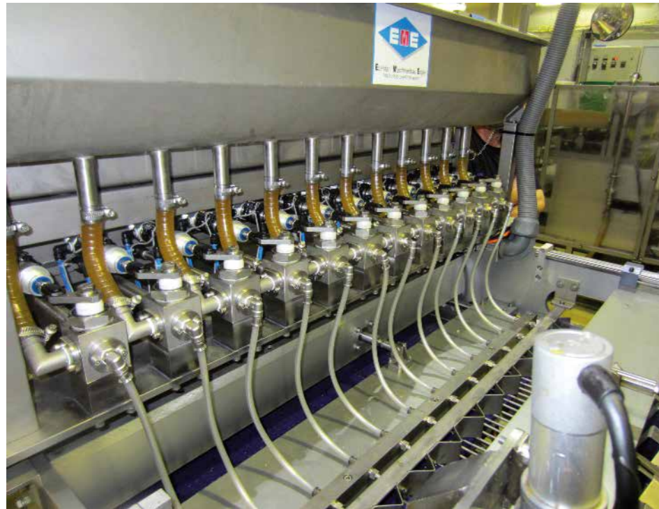
Automatische Befüllstation von Krapfen mit Konfitüre
