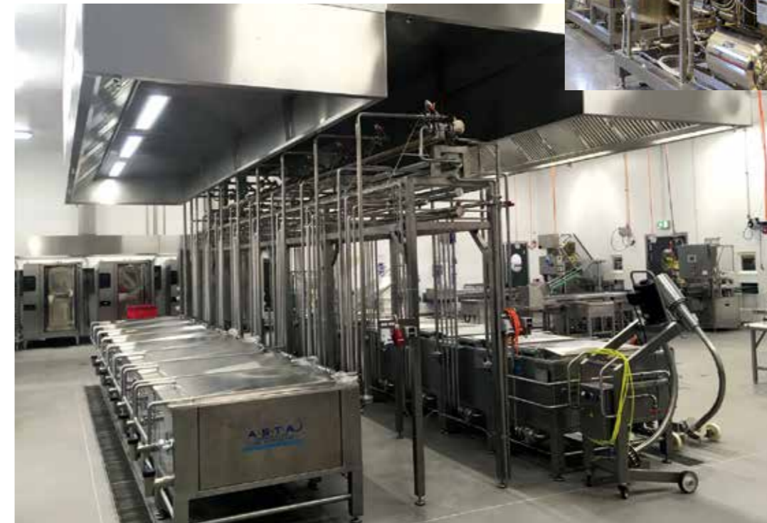
Beispiel für die Installation von Kochkesseln für den Batchbetrieb
