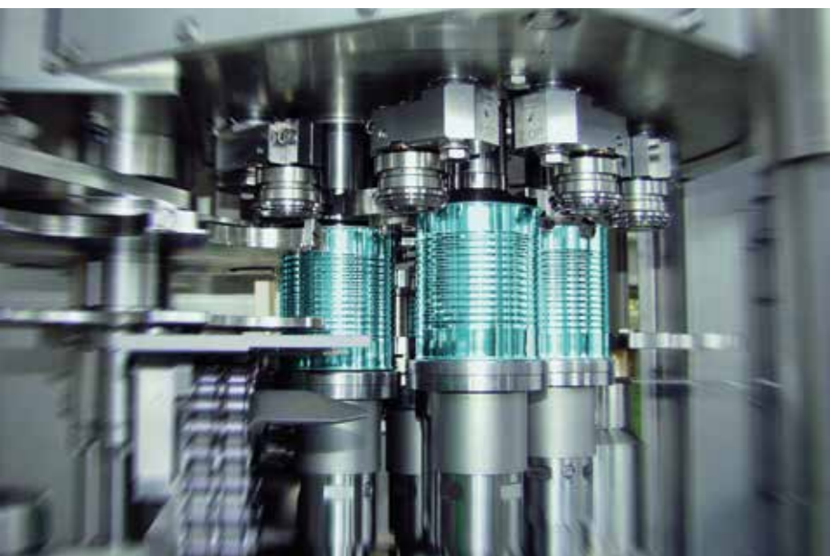
▲ Verschließen von 3-teiligen Konservendosen
