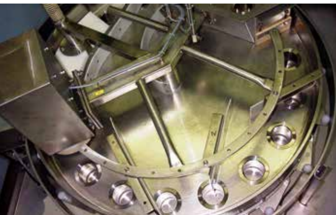
Füllmaschine zum Abfüllen von kleinstückigen Komponenten nach Volumen
