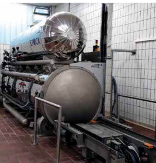
◀ Sterilisationsanlagen mit automatischer Zuführung der Autoklavenkäfige
