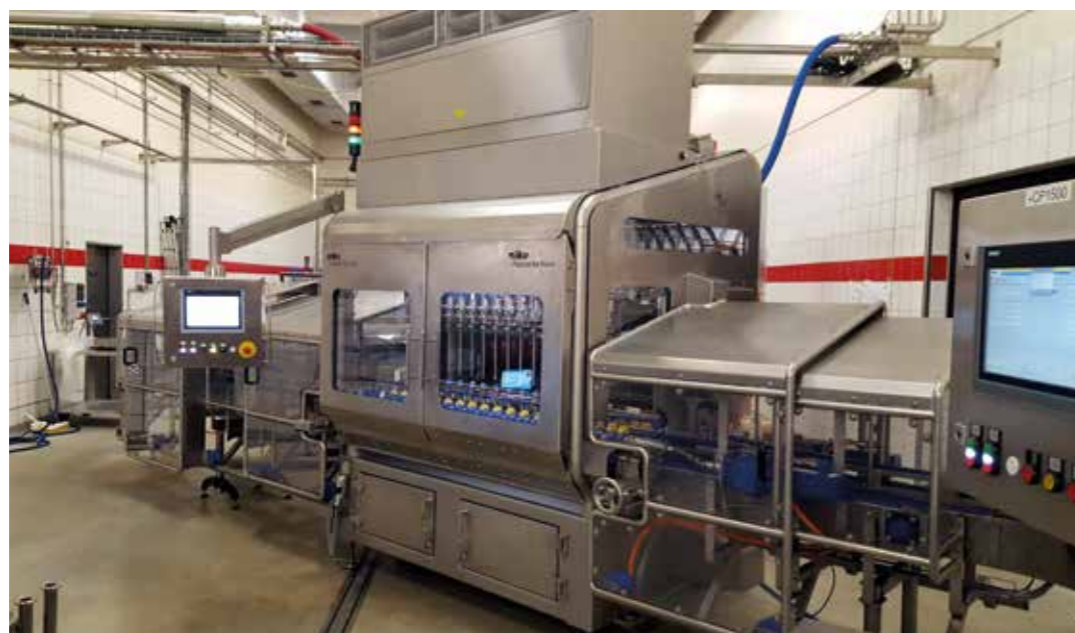
Reihenfüller zum Abfüllen von flüssigen oder pastösen Produkten
