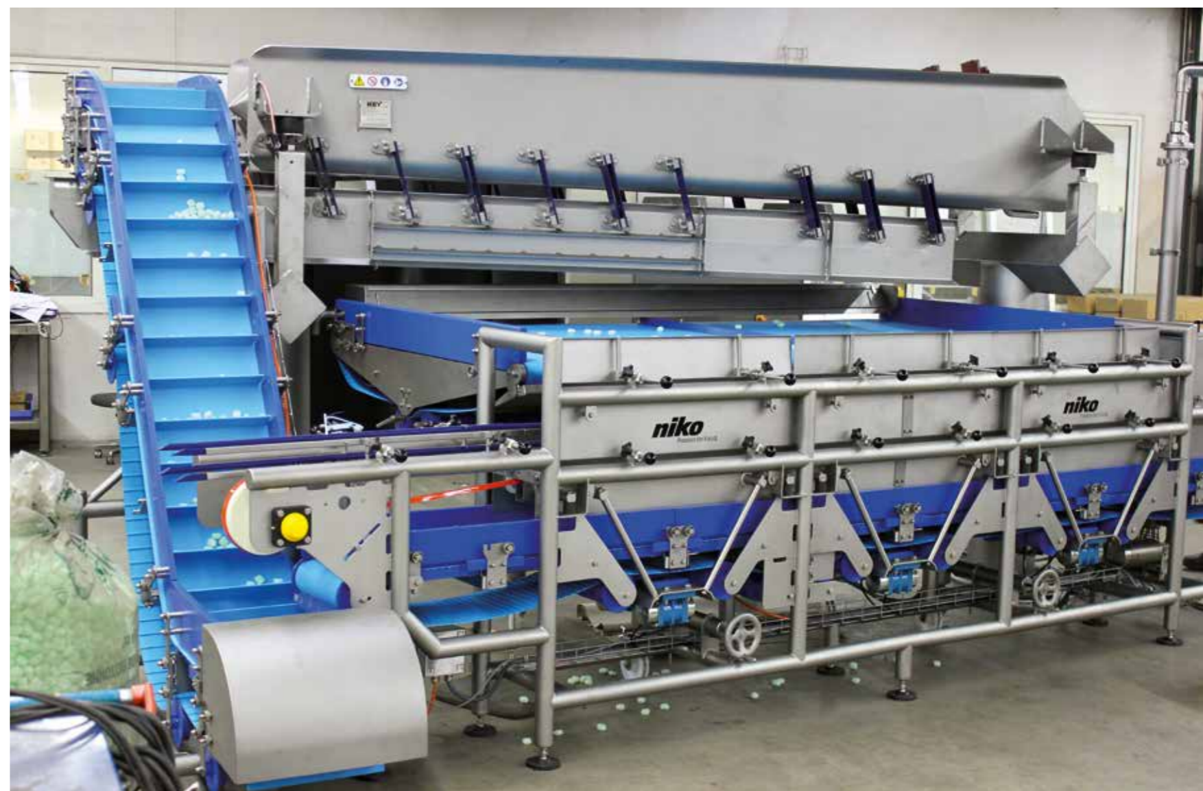
Neuentwickelte Hochleistungsfüllmaschine (HLF) für empfindliche Produkte
