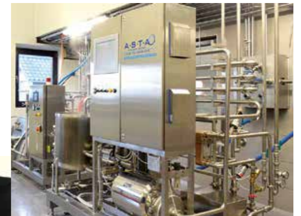
Kontinuierliche Pasteurisationsanlage für Molkereiprodukte
