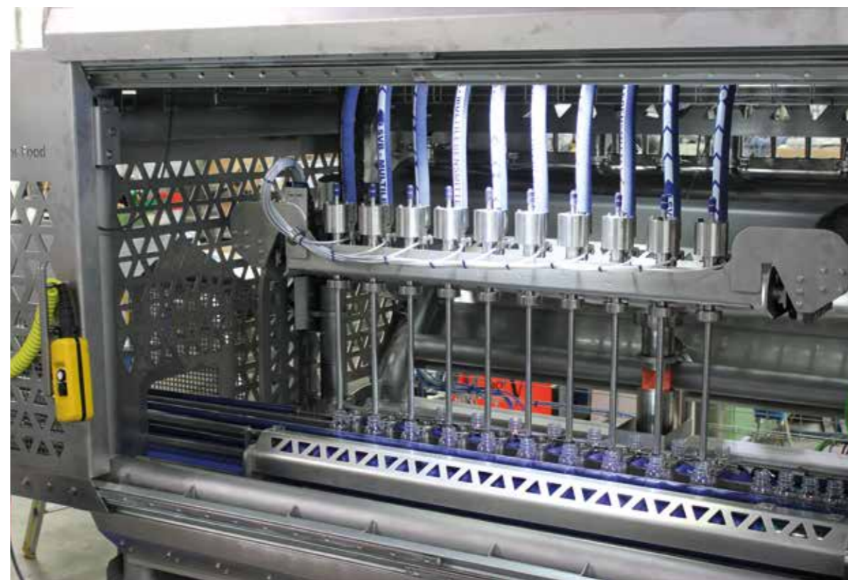
Reihenfüller für Kleinstgebinde für die pharmazeutische Industrie
